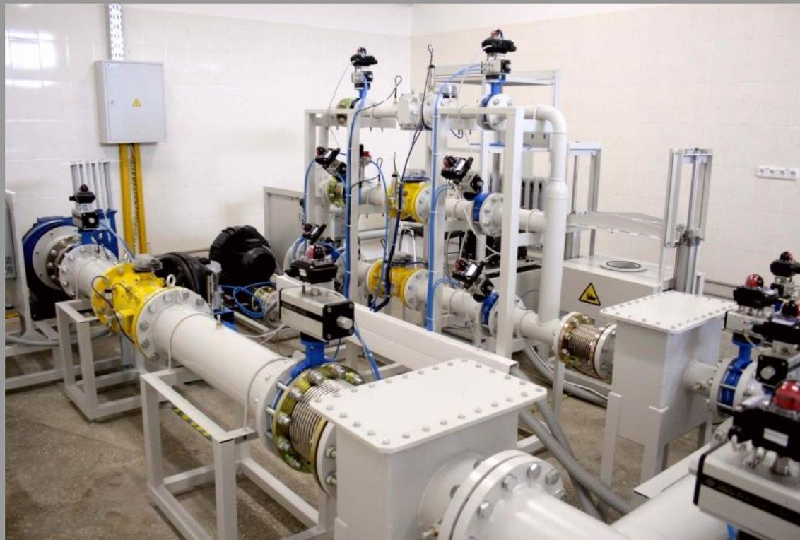
Поверка проводится в соответствии с ГОСТ 8.611-2013 “Методика (метод) измерений с помощью ультразвуковых преобразователей расхода”.
