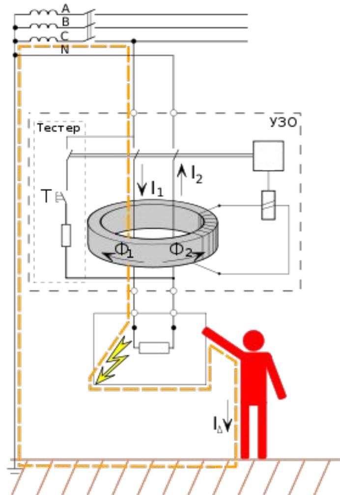
Схема УЗО и принцип работы
