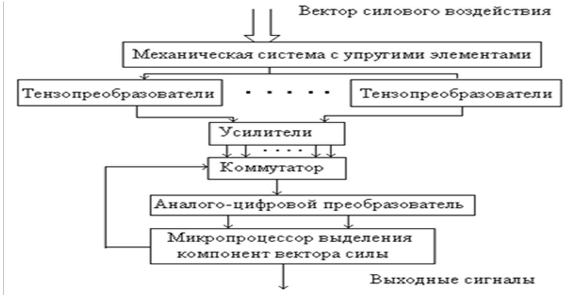
Схема силомоментного датчика
