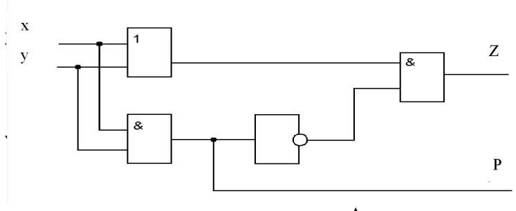
$P(X,Y)=X \wedge Y;$  $Z(X,Y)=(X \vee Y) \wedge \neg (X \wedge Y).$
