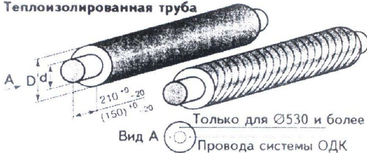
Рис. 6.30. Конструкция ППУ – изоляции трубопровода по технологии ЗАО «Мос-Флоулайн»
