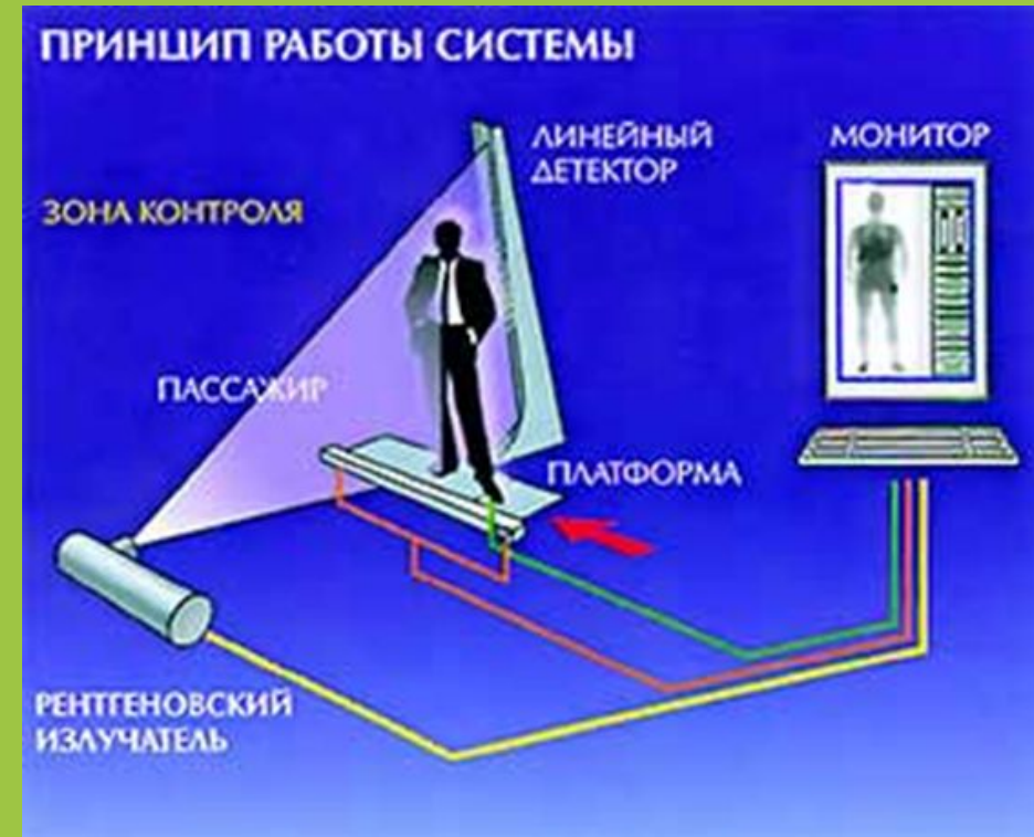
Рисунок №1. Принцип сквозного сканирования
