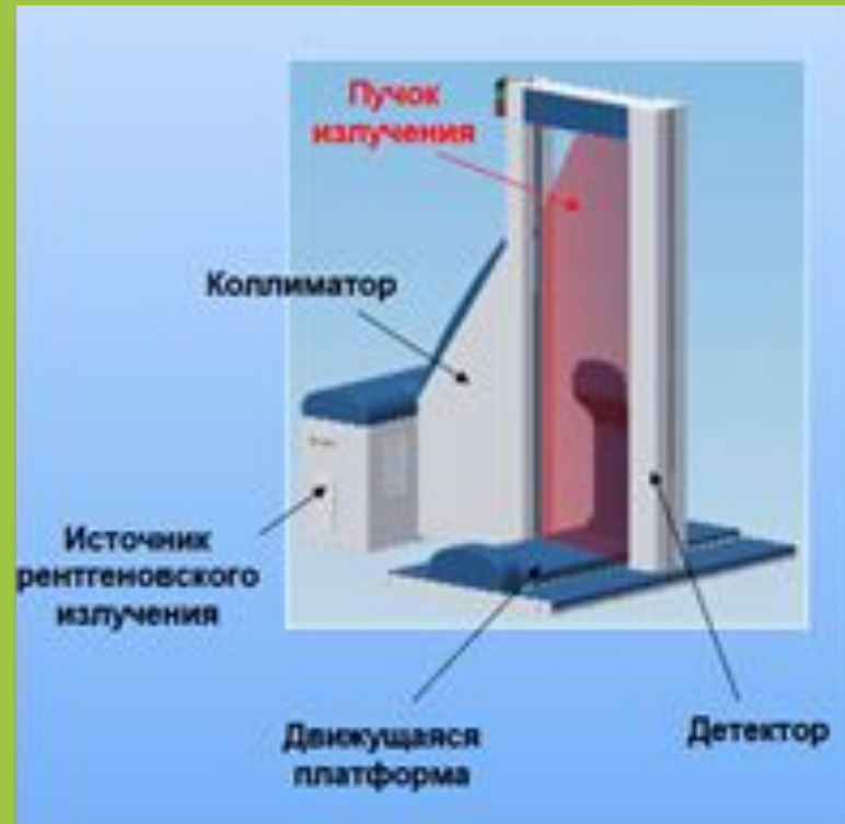
Рисунок №6. Конструкция рентгеновского сканера человека (сквозной метод сканирования)
