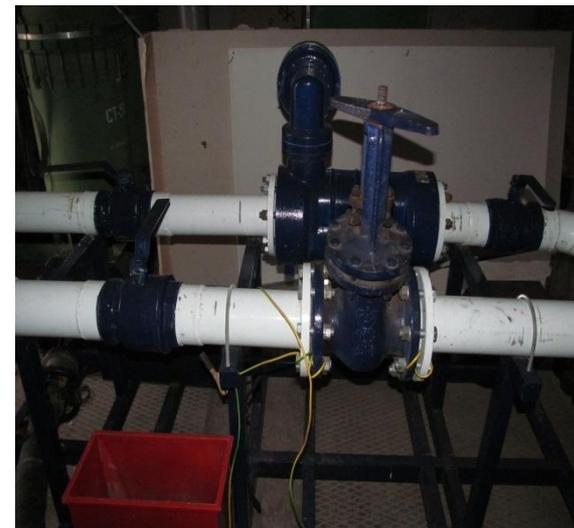
**Установка имеет две проверочные линии, в тыльной части объединенные в одну линию, к которой подсоединяется рукав с ННЗ**
