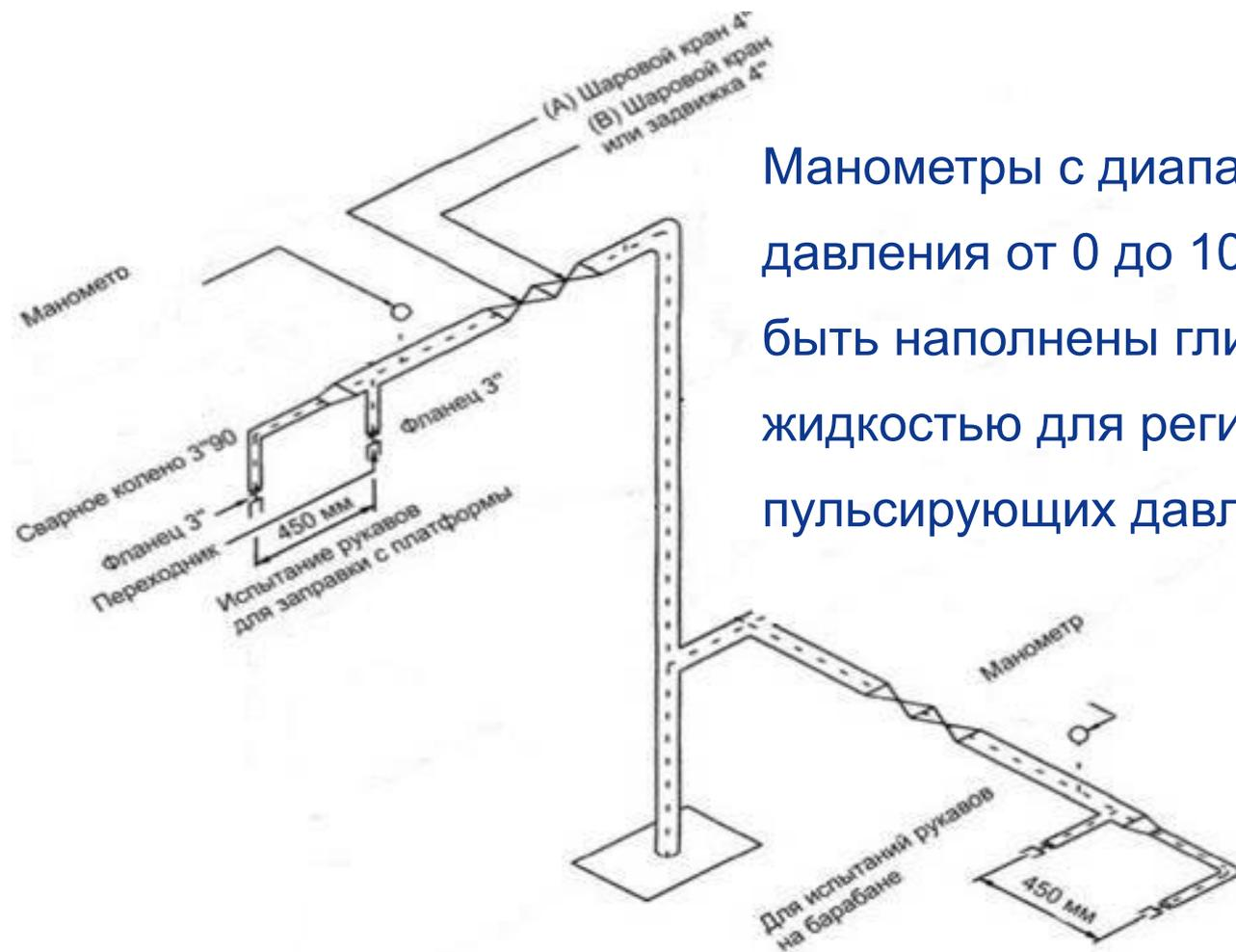
Манометры с диапазоном измерений давления от 0 до 10,5 бар не должны быть наполнены глицериновой жидкостью для регистрации пиковых пульсирующих давлений.
