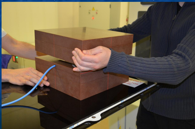
Рис. 5. Фантом Virtual Water в сборе с пленкой Gafchromic и ионизационной камерой: а – установка верхних пластин фантома; б – фантом с камерой в сборке
