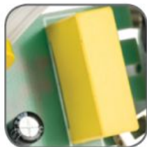
Дополнительный независимый релейный выход для сигнализации
