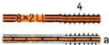
Автострады: 8—ширина одной полосы в метрах, 2—количество полос, Ц—материал покрытия (Ц—цементобетон, А—асфальтобетон); насыпи (4—высота насыпи в метрах)
