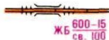
Эстакады: ЖБ—материал постройки, 600—длина, 15—ширина проезжей части в метрах, св. 100—грузоподъемность в тоннах
