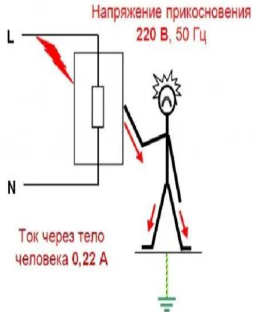
Корпус без заземления
