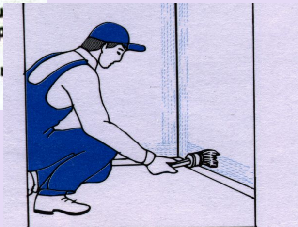
Рис. 164. Окраска отбивочного шнуром (а), отводка по верхней границе окраски кистью ручником (б) 1 – шнур; 2 – след от разметки шнуром
