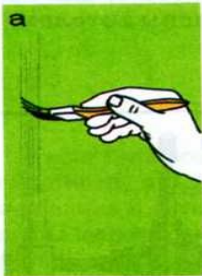
Рис. 167. Флейцевание (а) и торцевание (б) свежеекрашенной поверхности
