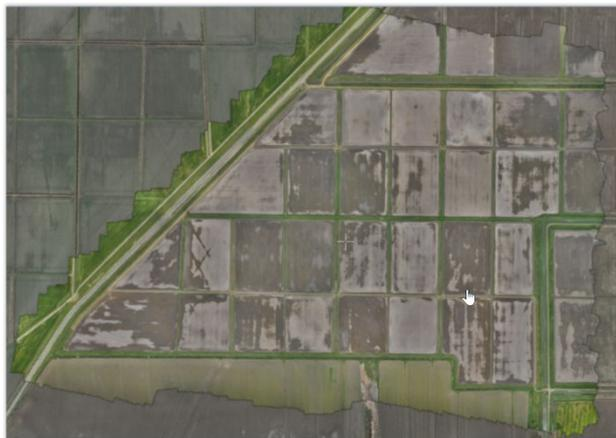
По результатам аэрофотосъемки могут быть созданы **ортофотоплан, карта высот, ЦММ** (цифровая модель местности)
