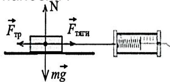
2)  $A = F_{тр} \cdot s$ ;  $F_{тр} = F_{тяги}$  (при равномерном движении);
