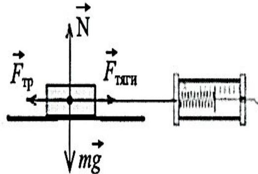
2)  $F_{тяги} = F_{тр}$  (при равномерном движении);
