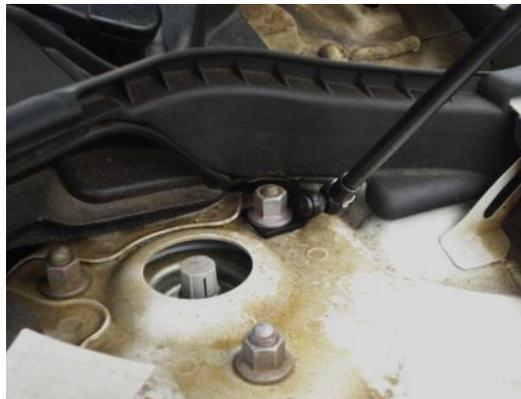
**Упереть амортизатор в твердую поверхность, несколько раз сжать и отпустить). Устанавливать амортизаторы штоком к моторному отсеку**
