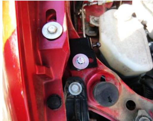
**Упереть амортизатор в твердую поверхность, несколько раз сжать и отпустить). Устанавливать амортизаторы штоком к крылу**
