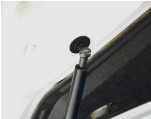
**Открутить гайку крепления амортизационной стойки и установить крепление**
