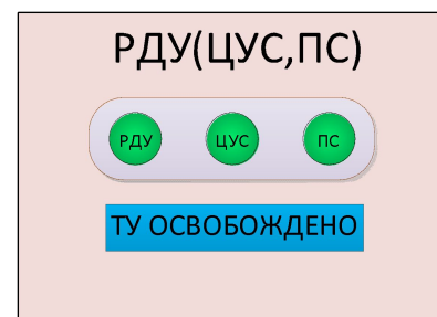
Ключ ТУ, индикаторы положения ключа ПС 220 кВ
