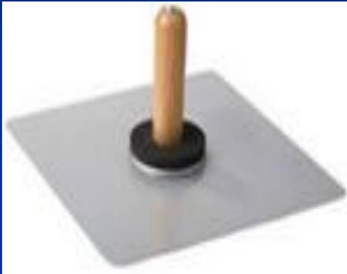
Применяется для того, чтобы раствор подносить порциями к поверхности, а также для намазывания раствора на поверхности.
