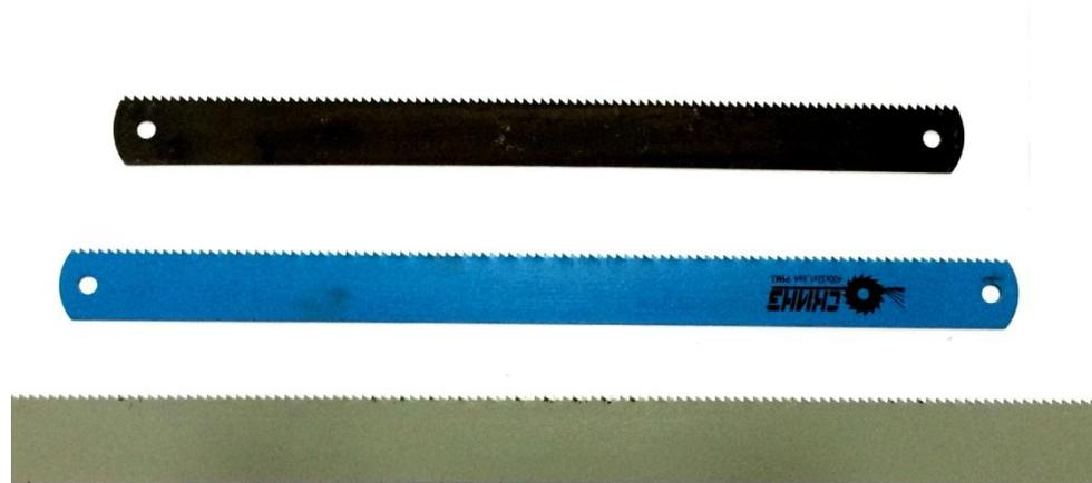
Ножовкой можно резать полосовой материал только в том случае, если на его толщине укладывается три и более зубьев ножовочного полотна. Более тонкий материал закрепляет между деревянными брусками. Тонкие заготовки собирают пакетами.
