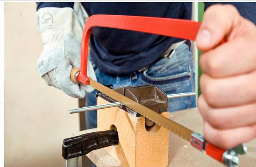
Ручные слесарные ножовки предназначены в основном для разрезания сортового и профильного проката вручную, а также для разрезания толстых листов и полос, прорезания пазов и шлицев в головках винтов, обрезания заготовок по контуру и др. работ.
