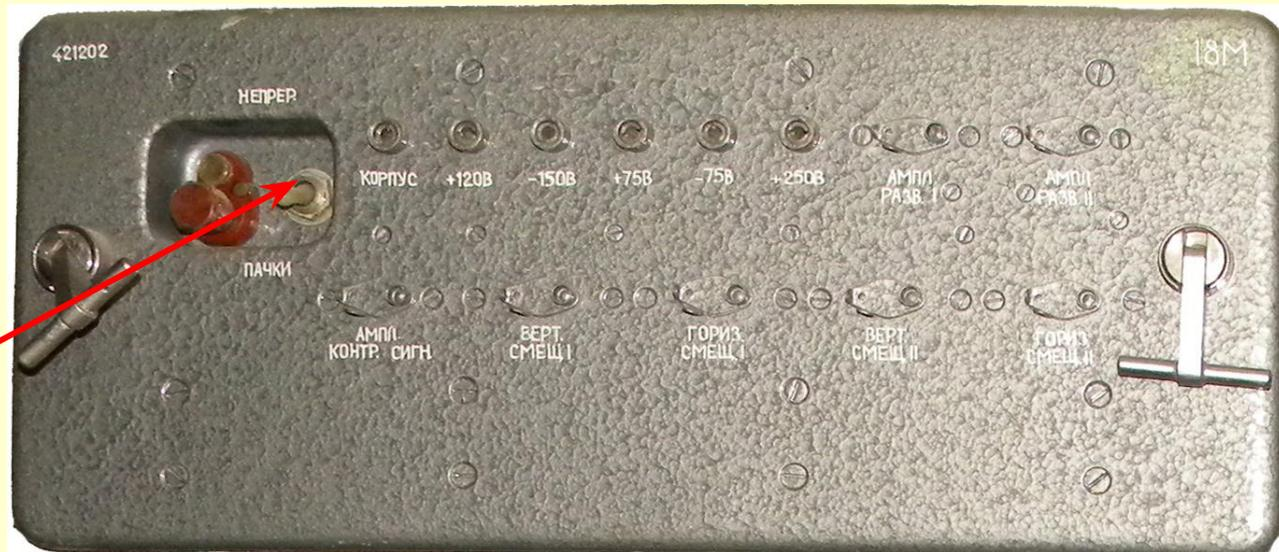
При установке тумблера В18-1 в положение НЕПРЕРЫВ. на триггер с усилителем +120В не подается.
