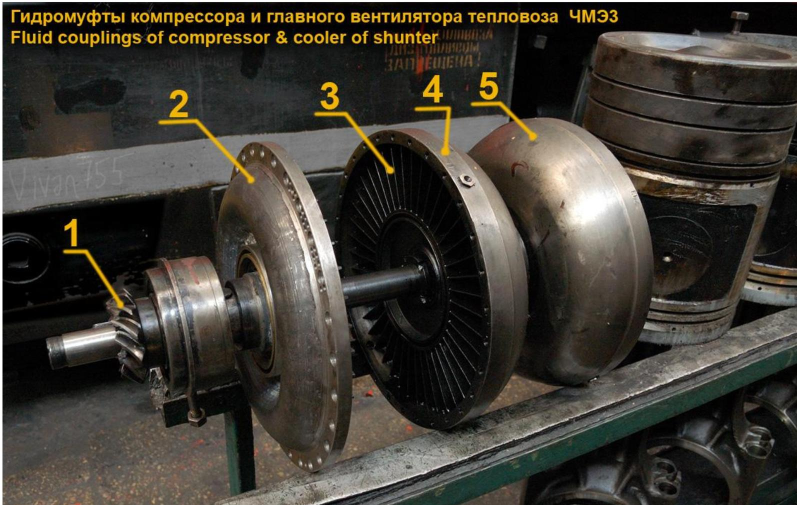
Гидромуфты компрессора и главного вентилятора тепловоза ЧМЭЗ
