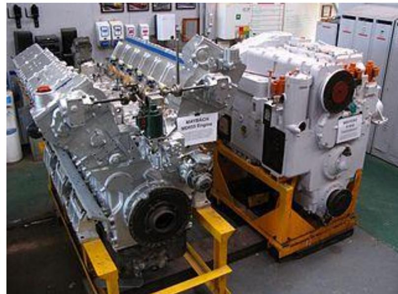
Дизельный двигатель (слева) и гидропередача (справа) тепловоза [Class 35](#)
