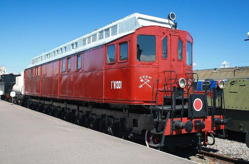
В 1924 г. в Ленинграде был создан магистральный тепловоз ГЭ1 (Щэл1) системы Я. М. Гаккеля мощностью 735 кВт (1000 л. с.) с электрической передачей.
