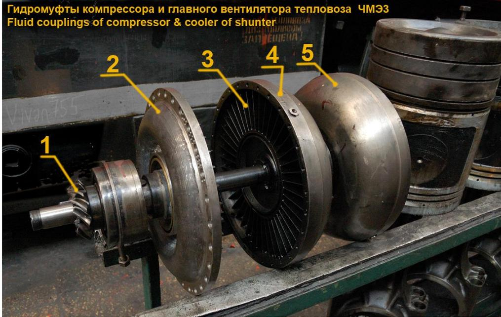
Гидромуфта состоит из насосного колеса, вращаемого двигателем, и турбинного колеса, с которого снимается мощность.
