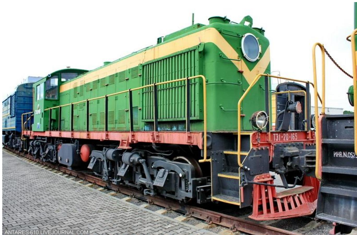
В 1953 г. был построен первый тепловоз ТЭЗ мощностью в двух секциях 2940 кВт (4000 л. с.), а с 1956 г. начато его серийное производство.
