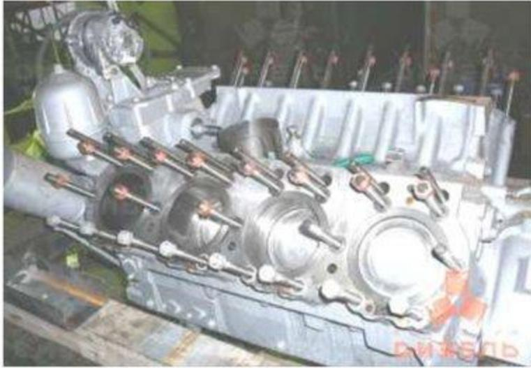
**Блок цилиндров** является базой для крепления остальных несущих деталей ДВС и размещения всех механизмов и навесного оборудования. Блок изготавливается из чугуна и подвергается искусственному старению (усадке). Для придания жесткости, блок имеет коробчатое сечение и перегородки. В перегородках имеются расточки под:
