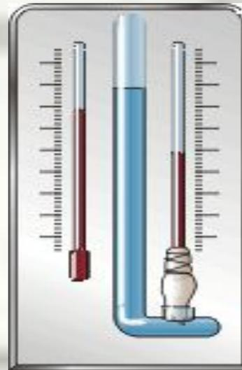
Психрометр Августа имеет два термометра: "сухой" и "влажный". Испарение воды с поверхности влажного термометра приводит к понижению его температуры. Второй же, сухой термометр, показывает обычную температуру воздуха. Измеренные психрометром значения температур можно перевести в значение относительной влажности воздуха по специальной таблице .
