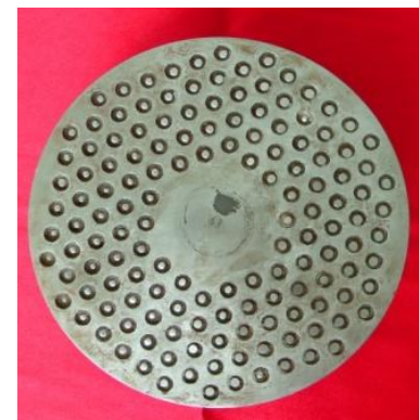
диаметр электродов 2 мм, расстояние между электродами 10 мм
