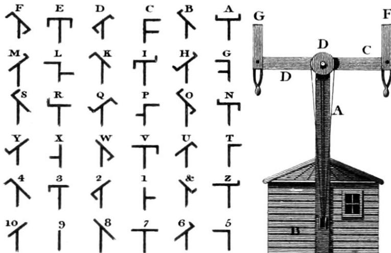
*Шапп создал специальную таблицу кодов, где каждой букве алфавита соответствовала определенная фигура, образуемая Семафором, в зависимости от положений поперечных брусьев относительно опорного шеста. Система Шаппа позволяла передавать сообщения на скорости два слова в минуту и быстро распространилась в Европе.*
