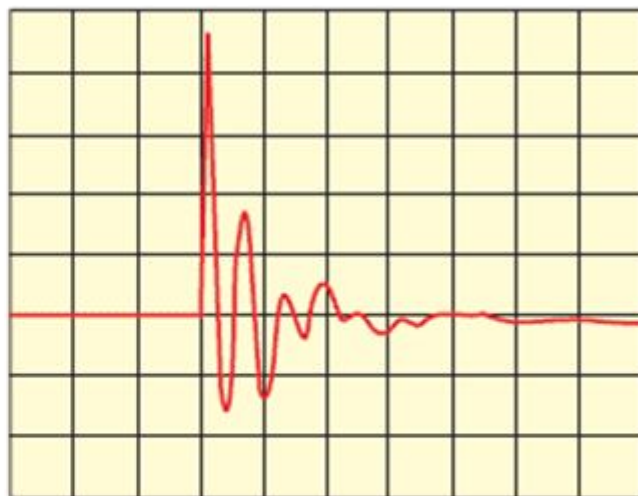
А – пусковой ток с обычным контактором
