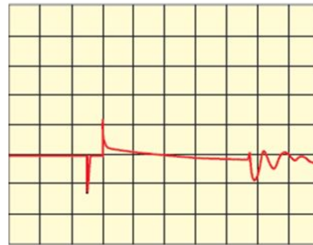
Б – пусковой ток конденсаторным контактором
