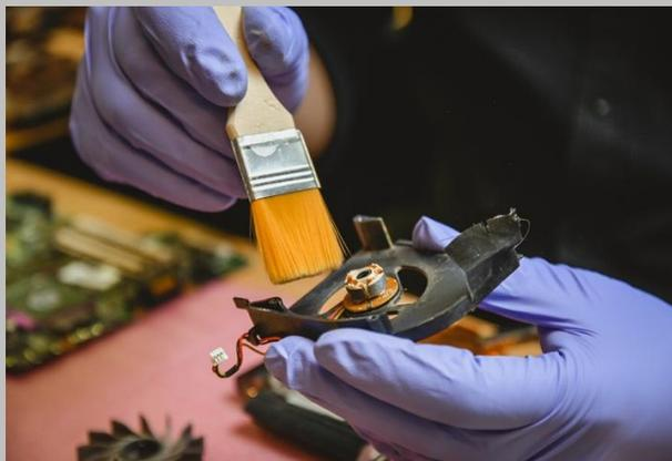
Смазываем посадочное место вентилятора, чтобы работал тише и дольше.
