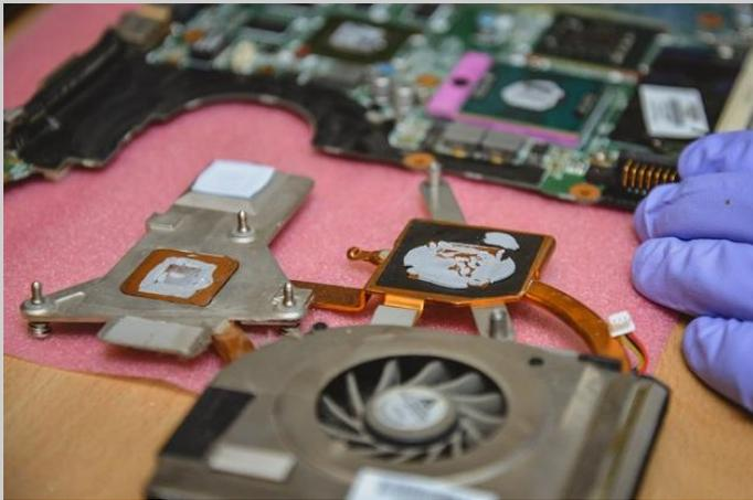
Термопаста сухая – это плохо, значит она не выполняла свою функцию, которая заключается в улучшении теплообмена между кристаллом микросхемы и радиатором, для улучшения охлаждения. Срок службы термопасты варьируется от 8 до 18 месяцев в зависимости от качества и состава.
