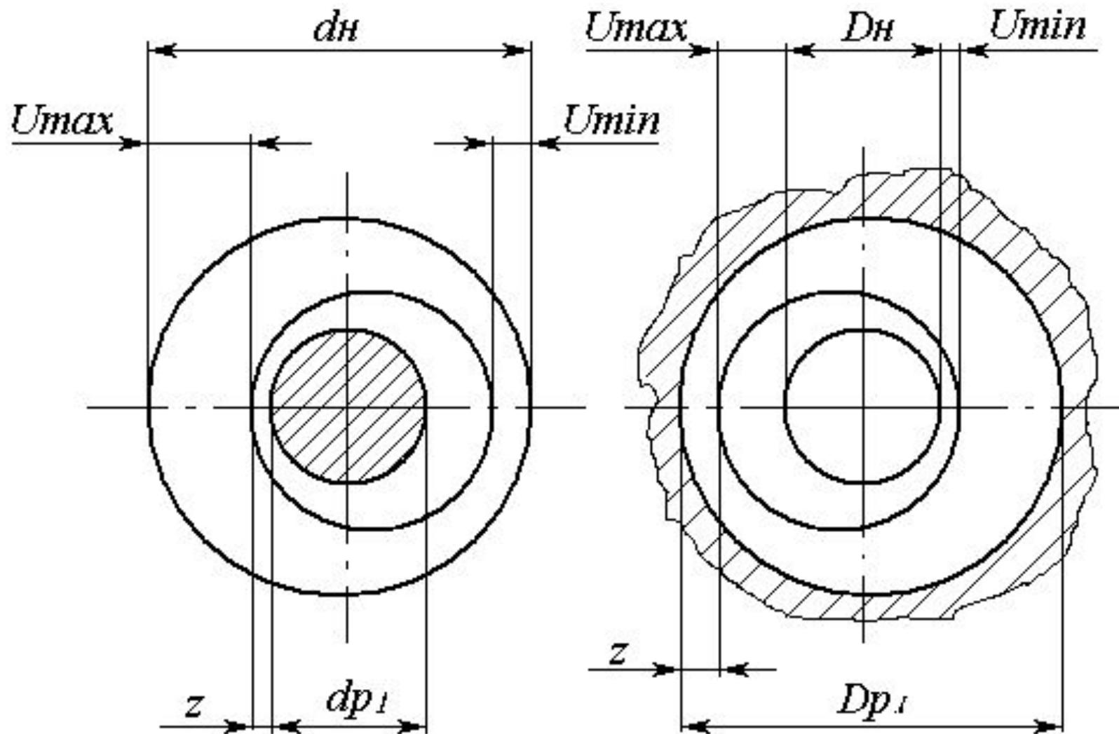
Рисунок 1 – Схема расположения номинальных и ремонтных размеров
