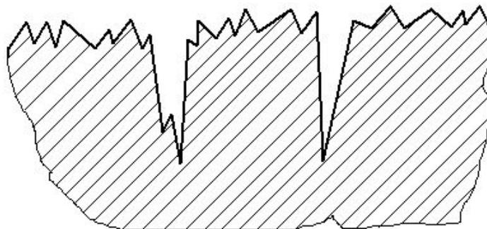
Рисунок 3 – Схема микропрофиля поверхности при хонинговании
