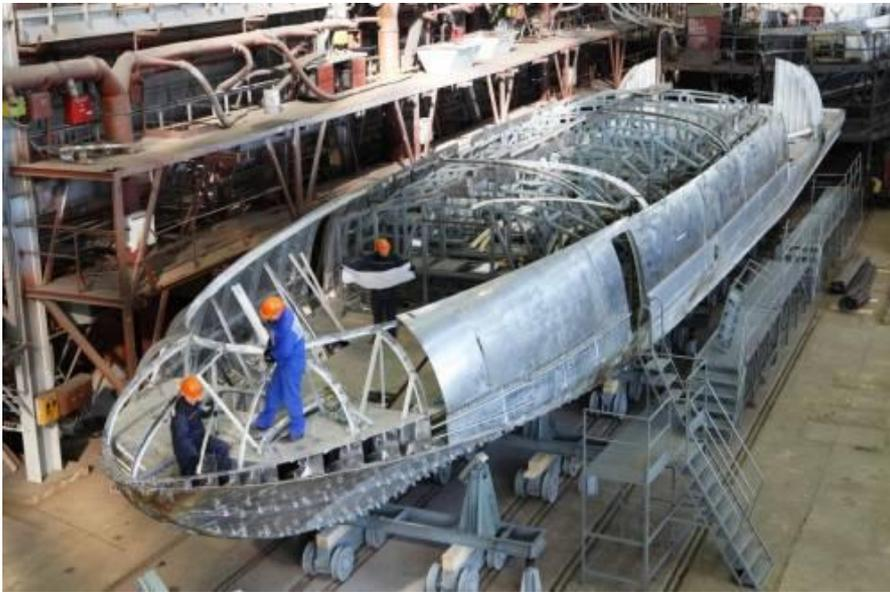
Алюминий и его сплавы применяют при отделке и изготовлении корпусов и дымовых труб судов, спасательных лодок, радарных мачт, трапов.
