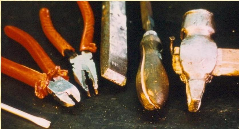
Не допускается использование напильников, шаберов, отверток, ножовок без рукояток и бандажных колец на них, и с ненадежно закрепленными рукоятками;
