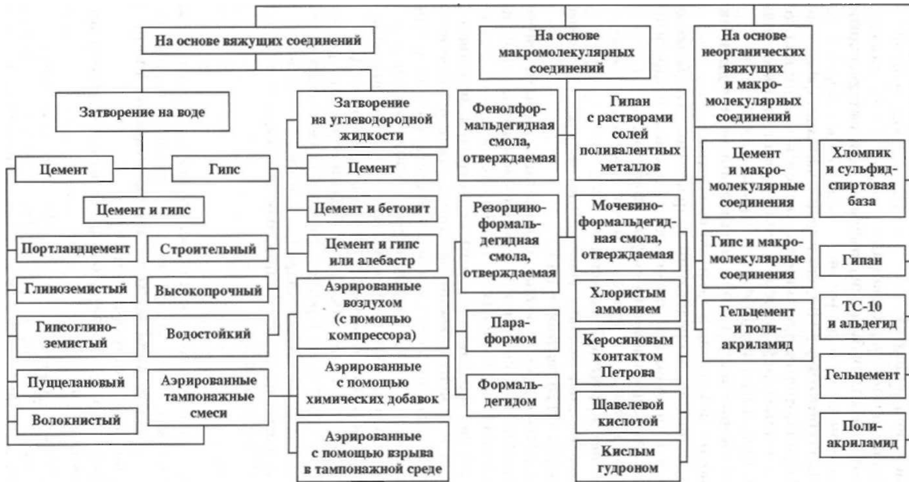
Рис. 8.4. Классификация тампонажных смесей для изоляции зон поглощения (по В.И. Крылову)
