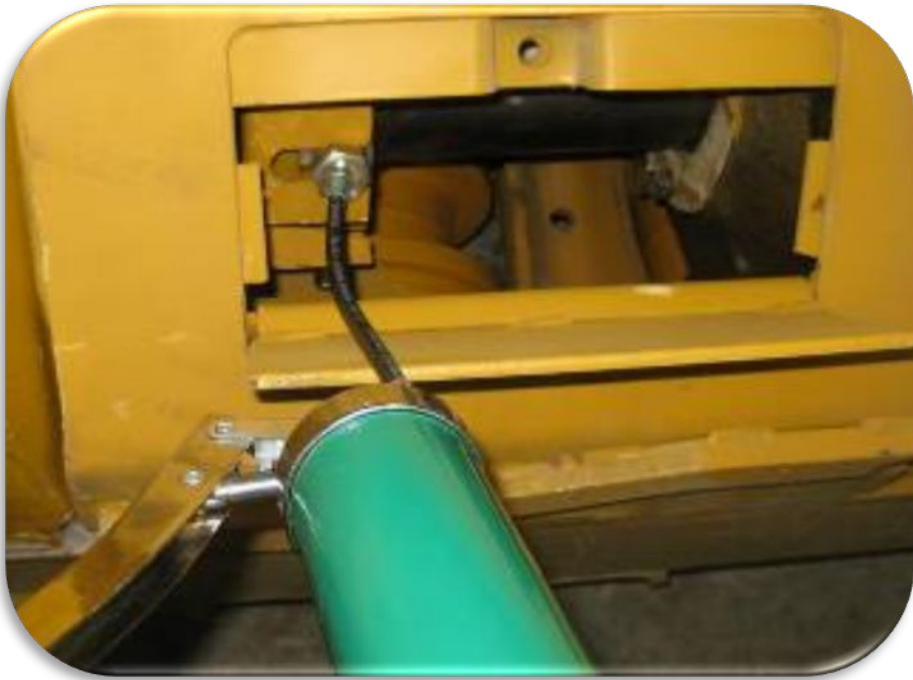
履带涨紧装置 Н а т я ж и т е л ь г у с е н и ц ы
