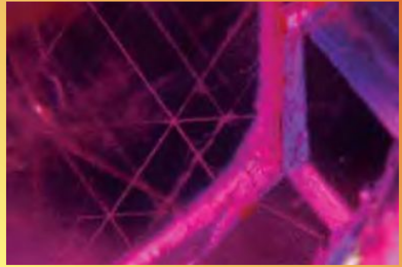
В результате пересечения ламеллей двойникования появляются «трубочки» 30х .
