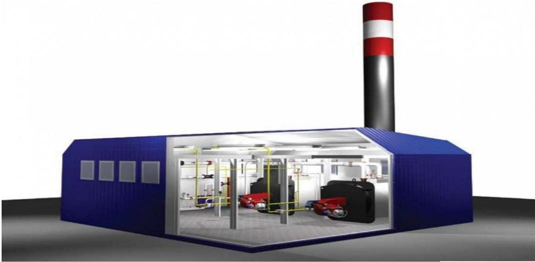
Большинство модульных котельных рассчитано на естественную приточно-вытяжную вентиляцию, для чего в контейнерах предусмотрены специальные клапаны и отверстия.
