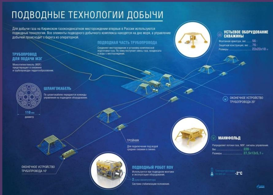
В составе объектов обустройства морских месторождений ПДК может иметь следующие функциональные элементы:
