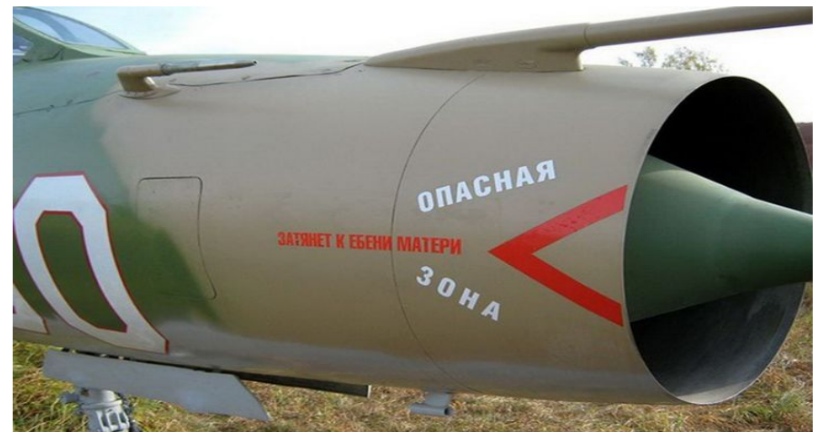
На режиме МАХ за одну секунду через воздухозаборник МиГ-21 проходит 60 кг воздуха.
