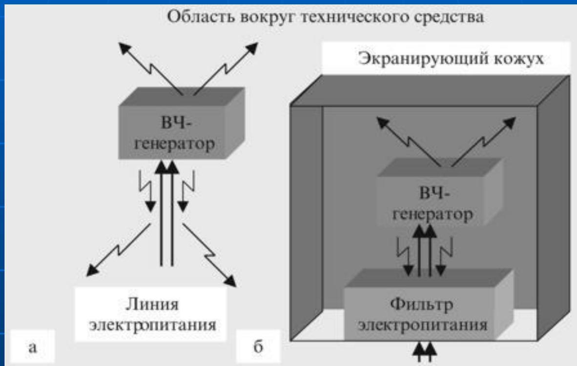
**Электромагнитное экранирование основано на замыкании экраном, обладающим высокой электропроводностью и (или) магнитопроводностью электрического и магнитного полей соответственно.**
