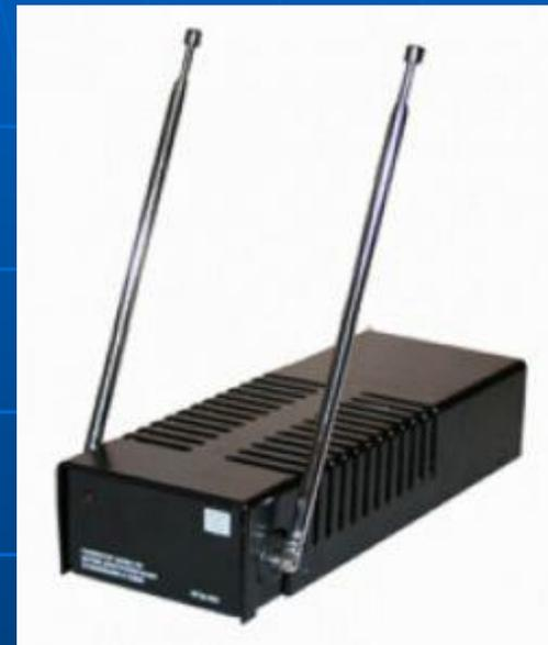
Данные генераторы могут применяться для защиты широкого класса технических средств: электронно-вычислительной техники; систем звукоусиления и звукового сопровождения; систем внутреннего телевидения и т.д.
