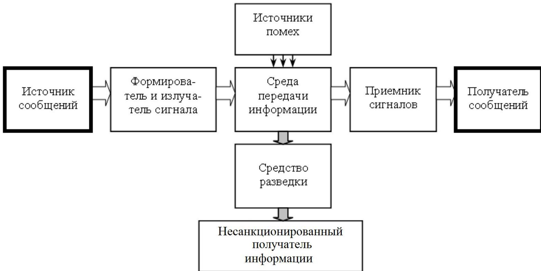
**Технический канал утечки информации** представляют собой **совокупность объекта разведки, технического средства разведки, с помощью которого добывается информация об этом объекте, и физической среды, в которой распространяется информационный сигнал.**
