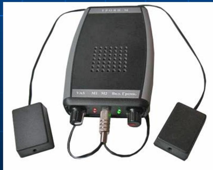
**При виброакустической маскировке формирования акустических помех применяются специальные генераторы, к выходам которых подключены вибрационные излучатели, установленные на окнах, стенах и т.д.**
