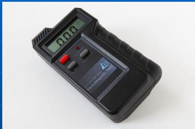
**Индикаторы поля выявляют практически все виды радиосигналов, включая широкополосные шумоподобные сигналы, сигналы с псевдослучайной скачкообразной перестройкой несущей частоты и т.д.**
