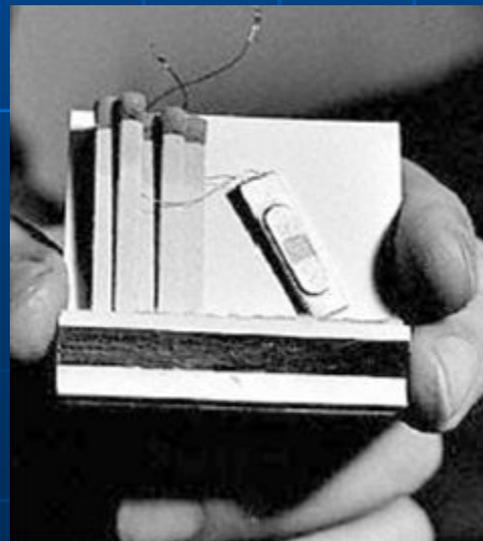
**Автономные устройства, конструкционно объединяющие миниатюрные микрофоны и передатчики, называют закладными устройствами перехвата речевой информации, или просто акустическими закладками.**
