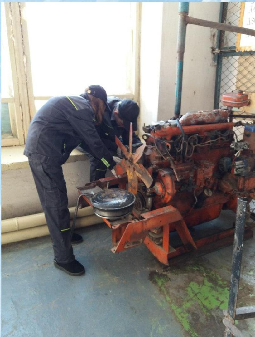
**Разбор головки двигателя**
