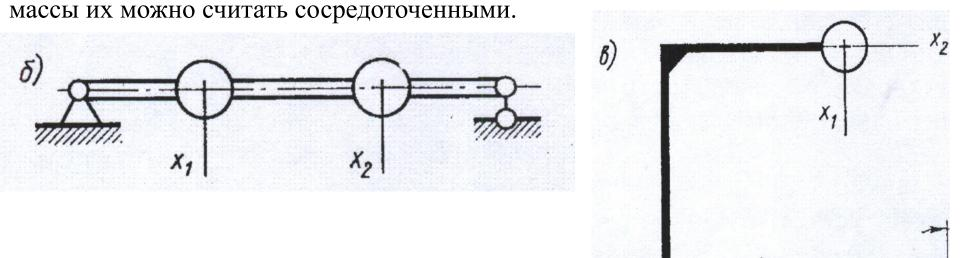
В случае больших поперечных размеров груза (рис.2,г) положение его определяется смещением центра массы  $x_1$  и углом поворота груза  $x_2$ . Такая система имеет две степени свободы.
