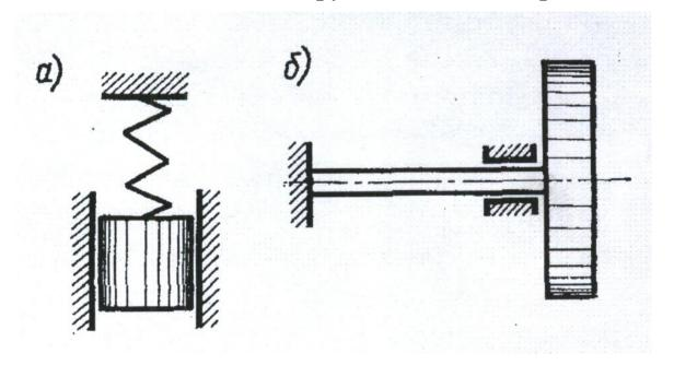
Другим примером систем с одной степенью свободы может служить диск, закрепленный на упругом валике (рис.1, б). Если масса вала пренебрежимо мала по сравнению с массой диска, а диск может перемешаться только поворачиваясь в своей плоскости вокруг оси вал.
