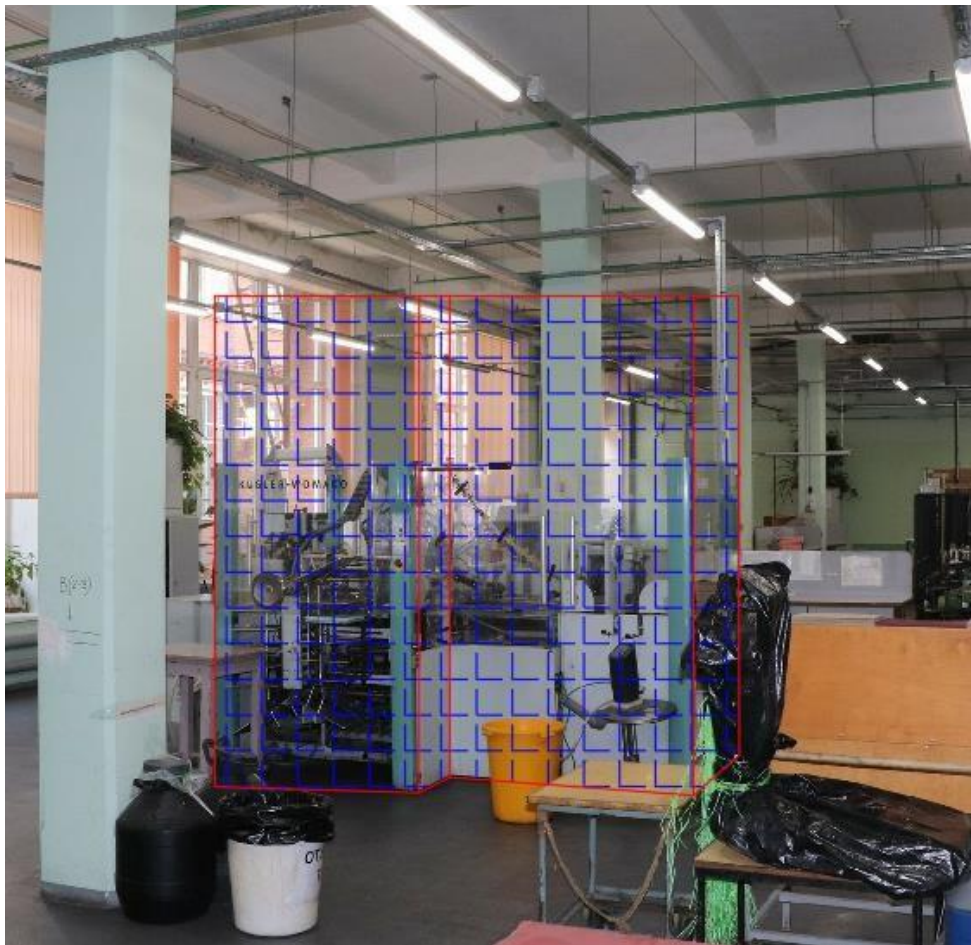
Рисунок 4.6.13 – Места установки монолитного поликарбоната на «Куглер»
