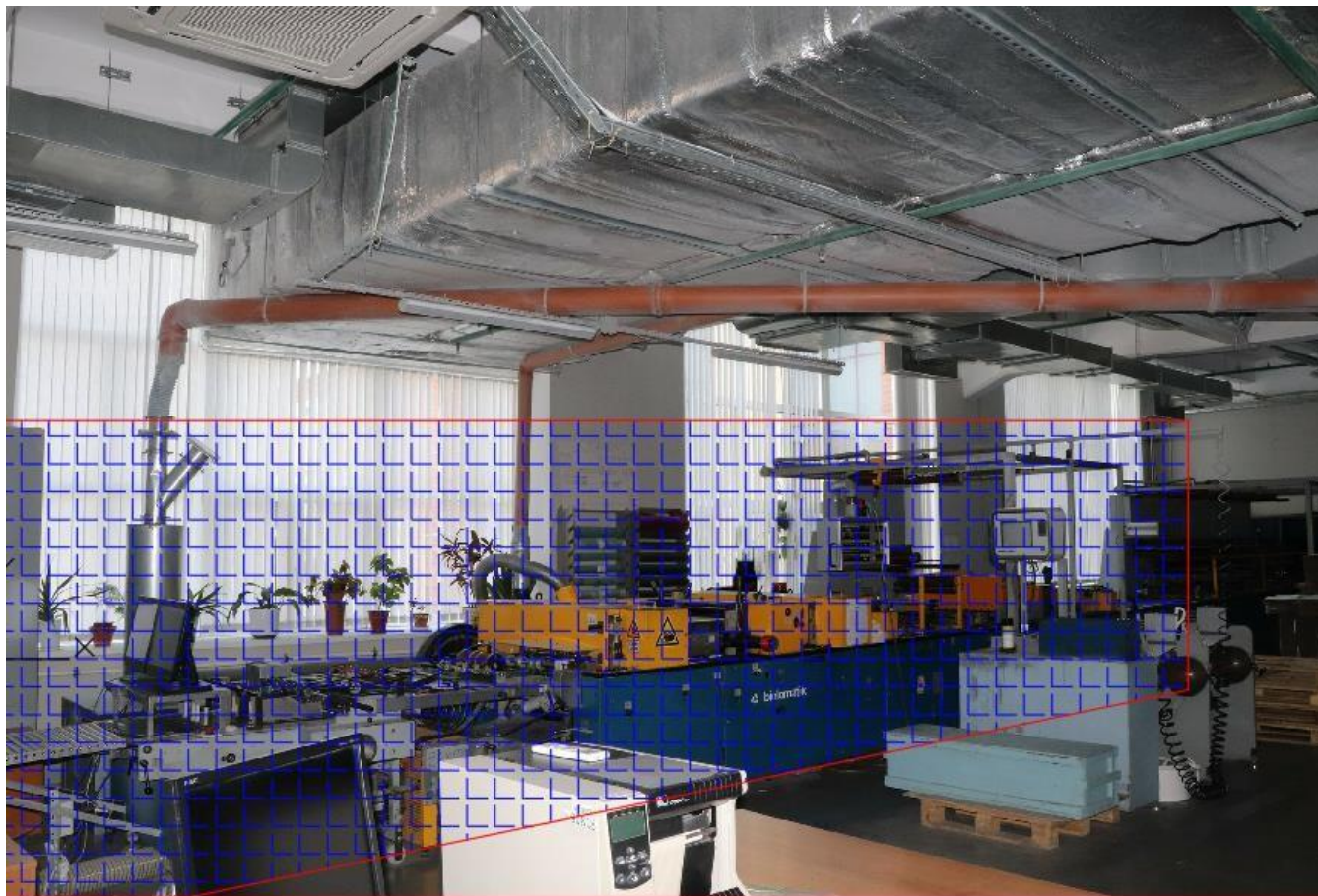
Рисунок 4.1.3 – Установка экрана вокруг машины «Коллатор»
