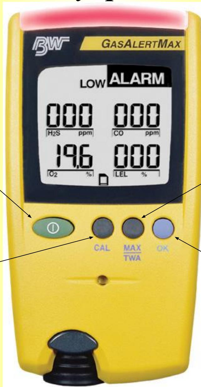
Кнопка **ВВЕРХ/TWA-MAX**, при одновременном нажатии с кнопкой **ОК** прибор показывает максимальную концентрацию выброса газа и среднее значение, зафиксированное за последние 8 часов
