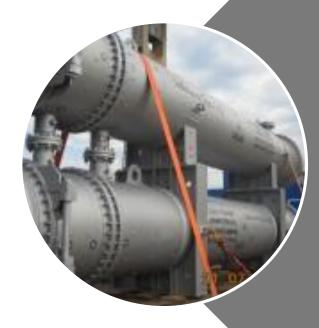
Теплообменное оборудование выпускается по СТО 2.3.006-2014 «Теплообменники кожухотрубчатые»
