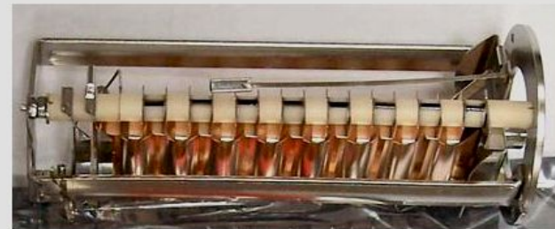
Электронный умножитель масс-спектрометра Thermo Electron DFS
