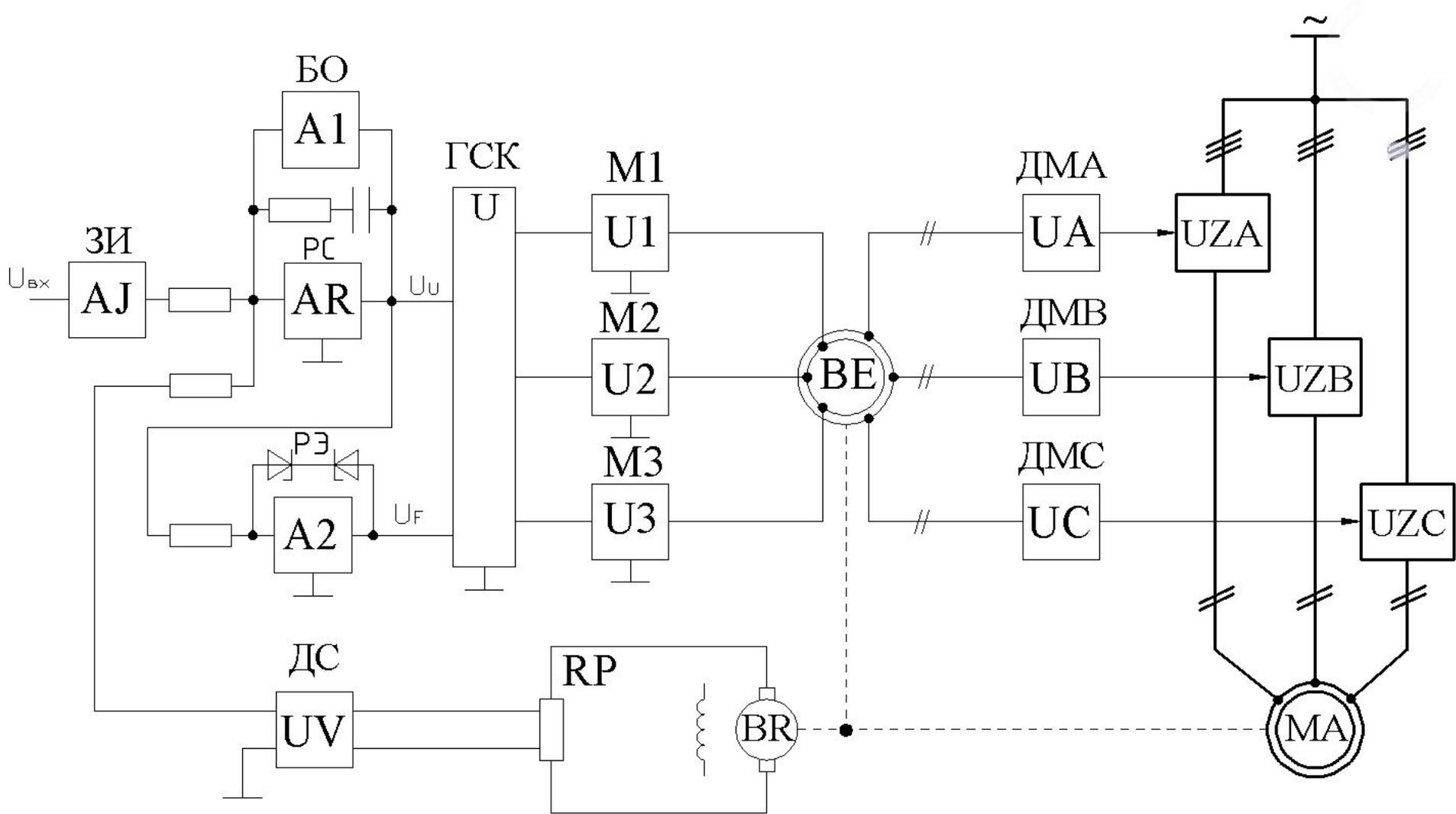
Схема функциональная асинхронного электропривода с частотно-токовым управлением
