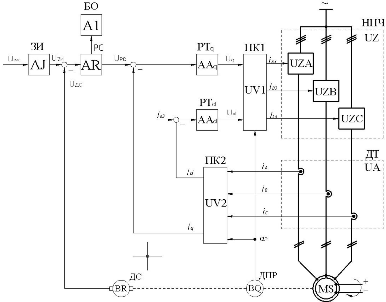
Схема функциональная синхронного частотнорегулируемого электропривода с выделением продольной и поперечной составляющих тока статора
