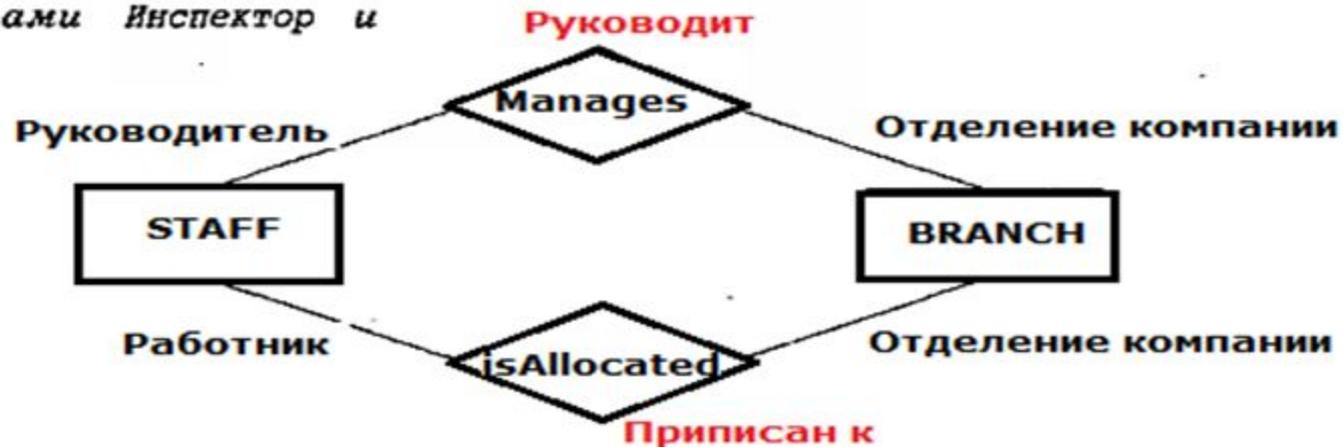
*Пример сущностей, связанных двумя различными связями Manages и isAllocated, с указанием ролевых имен*
