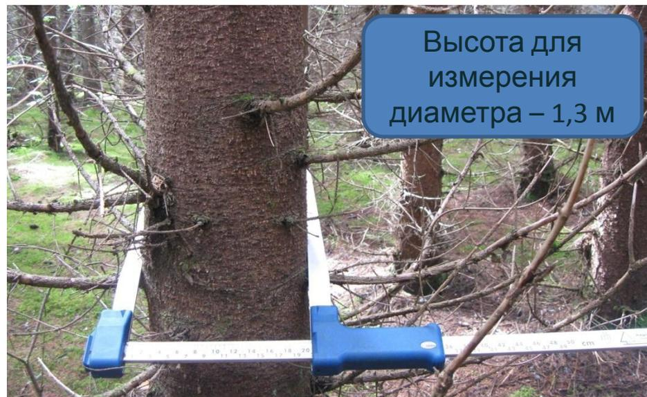
Если нет под рукой мерной вилки, то можно воспользоваться обычным «портновским метром» и измерить окружность ствола. Затем окружность разделить на число «пи» (3,14). Так мы вычислим точный диаметр дерева.
