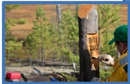
На углах постоянных пробных площадей устанавливаются столбы
