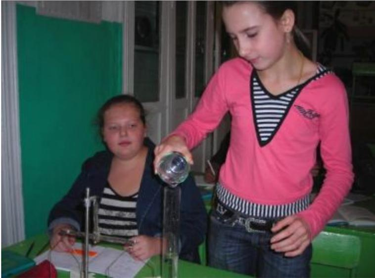
Мы взяли ролик, измерили его объем, опустив в мензурку с водой, затем взвесили ролик на весах и рассчитали плотность вещества,
