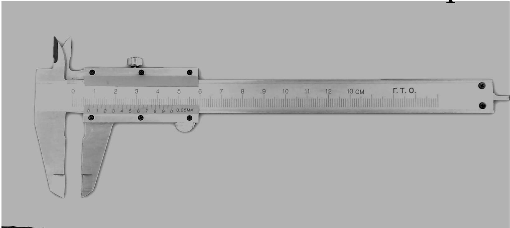
Вторая ножка расположена на подвижной части, которая может передвигаться вдоль линейки. Между ножками образуется зазор, в который вставляется измеряемый предмет. На подвижной части нанесены деления **нониуса**.
