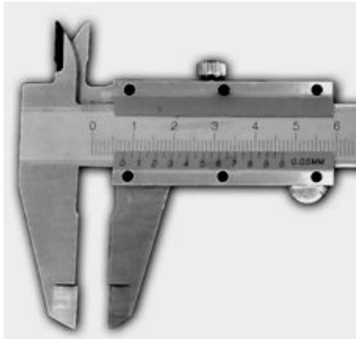
**Нониус** – ЭТО вспомогательная шкала, которая позволяет производить более точный отсчёт.
