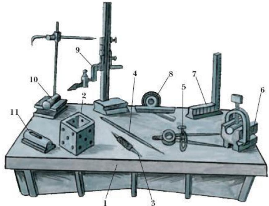
На разметочной плите устанавливают подлежащие разметке детали и располагают все приспособления и инструмент. Разметочная плита отливается из мелкозернистого серого чугуна.
