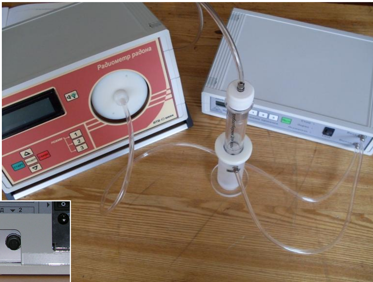
Перевод и измерение пробы в РРА-01М-03
