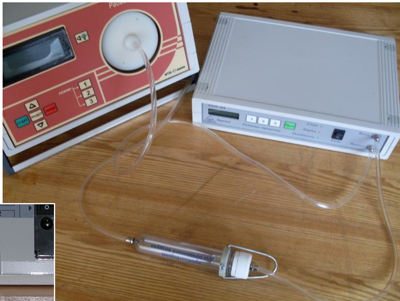
Перевод пробы в радиометр из пробоотборника
