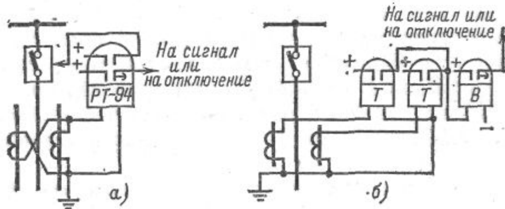
Рис. 18-12. Токовая защита от перегрузки.
