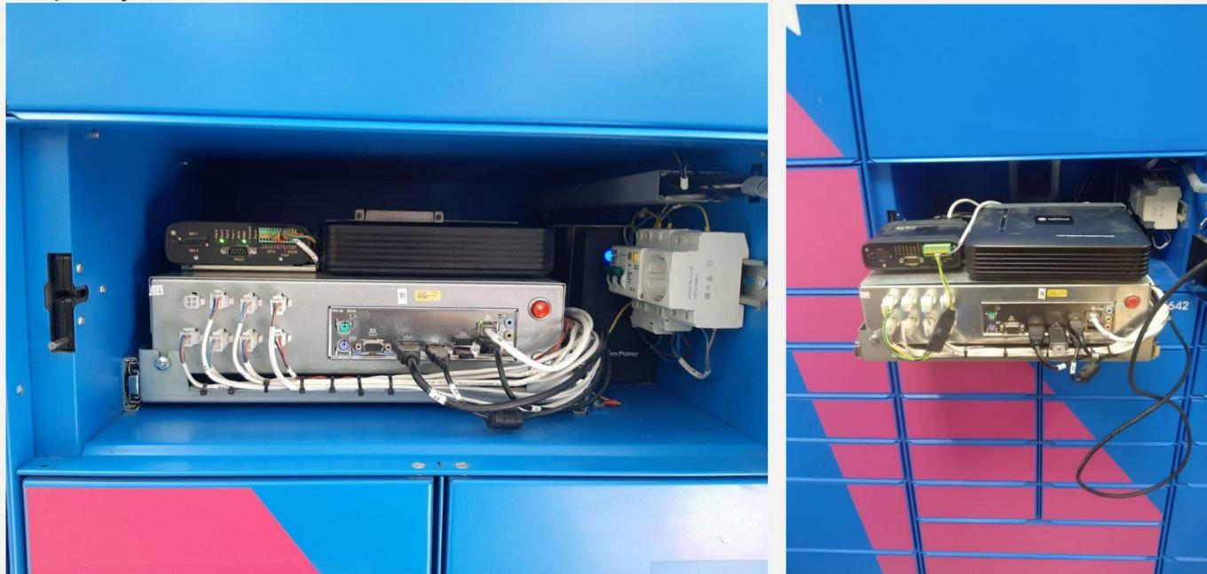
На крышке каретки располагаются видеорегиистратор (DVR) и 4G роутер IRZ. К роутеру подключается плата управления замками через разъем GPIO, работающая по протоколу RS485.
