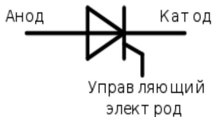
**Тиристор (thyristor)** — полупроводниковый прибор, выполненный на основе монокристалла полупроводника с тремя или более p-n – переходами и имеющий два устойчивых состояния: закрытое состояние, то есть состояние низкой проводимости, и открытое состояние, то есть состояние высокой проводимости.
